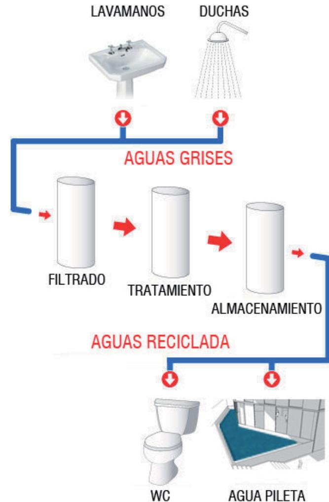
Entonces el agua tratada es bombeada al depósito de almacenamiento y durante este proceso se desinfecta mediante rayos ultravioleta de lámpara UV. Finalmente, si el agua requerida supera aquella producida durante este procedimiento, el sistema permite la incorporación de agua potable de red para satisfacer el suministro. Los filtros utilizados en este sistema son dos: arqueta de recogida y bombeo modelo ddc – v – 03 (para 300 habitantes).
