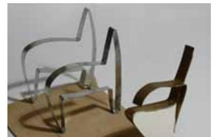
Se realizó una probeta de funcionamiento del elemento flexible comprobándose que no requería perfiles entre cada elemento rígido.
