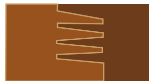
Ensamble tipo finger; para unir 2 maderas
