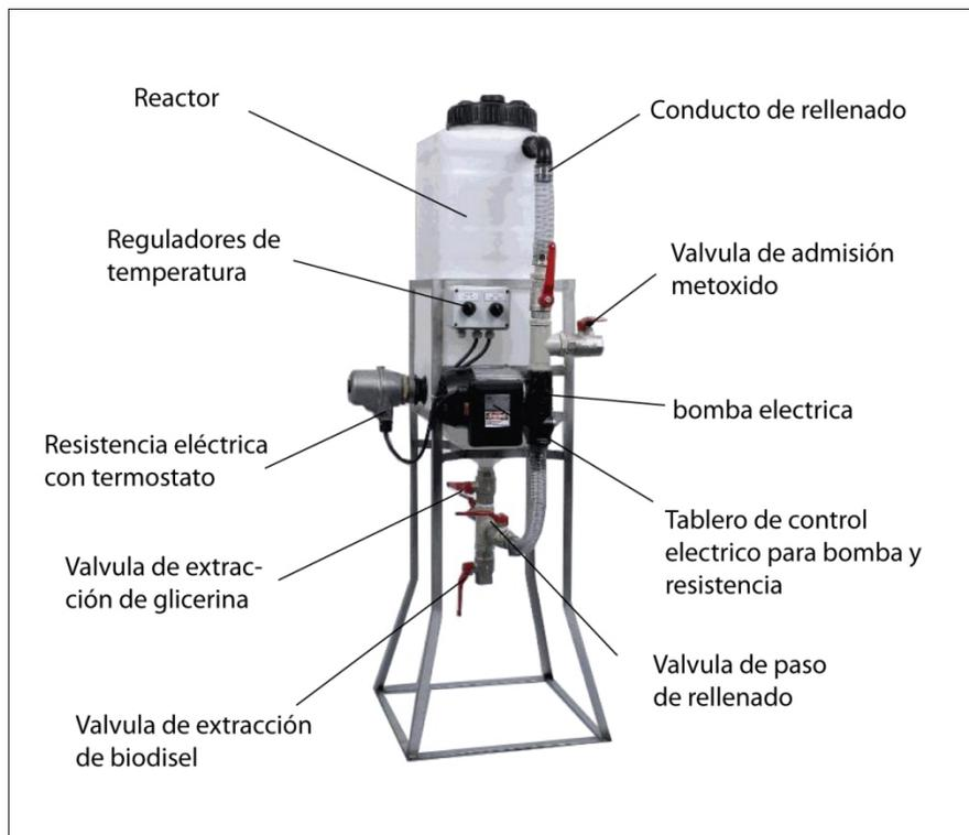
Esquema3: Reactor comercial de baja complejidad Marca/Modelo Biodis R-50, con capacidad máxima del reactor 50 litros.
