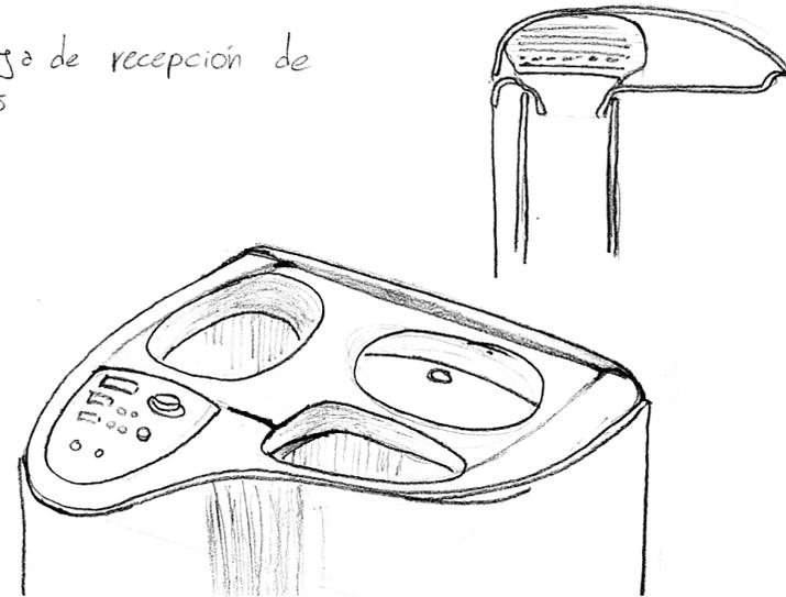
Con esta bandeja y entradas cónicas se cautela el correcto vertido de los materiales, independiente la fuerza del operario o de su precisión, el material es forzado a entrar por las aberturas al final del cono y si esto no fuera suficiente y algún resto de material lograra salpicar hace el exterior del cono, la curva inclinada hacia el frente desplazaría el flujo hacia adelante donde es más fácil efectuar la limpieza posterior (Esquema 14).
