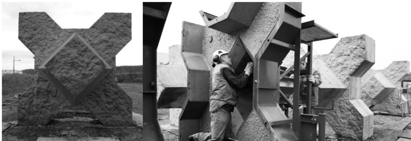
Imagen de Moldajes y Eco X-Bloc. Con un ph reducido para su aceptación por el medio.
