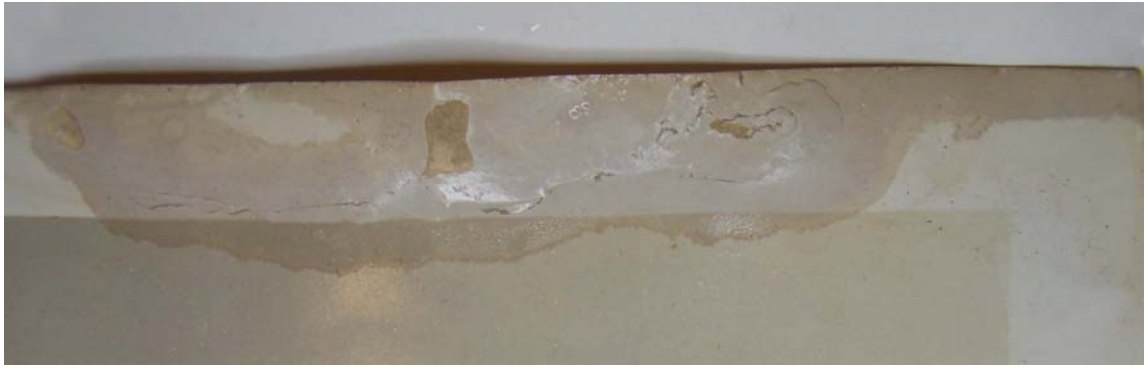
Estado de la zona afectada después de despegarla del vidrio.
