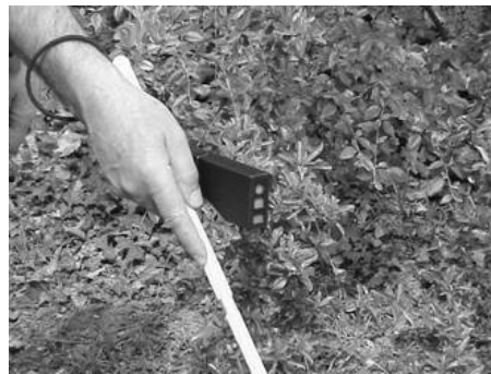
Figura 13. Teletact utilizado junto con el bastón (Leroux et al., 2004)
