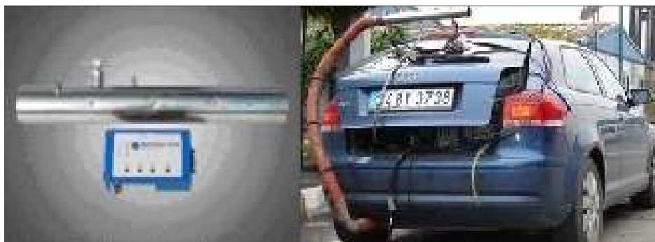
Figura 3-1: Flujiómetro utilizado y vista de montaje de equipo de recolección en vehículo liviano
