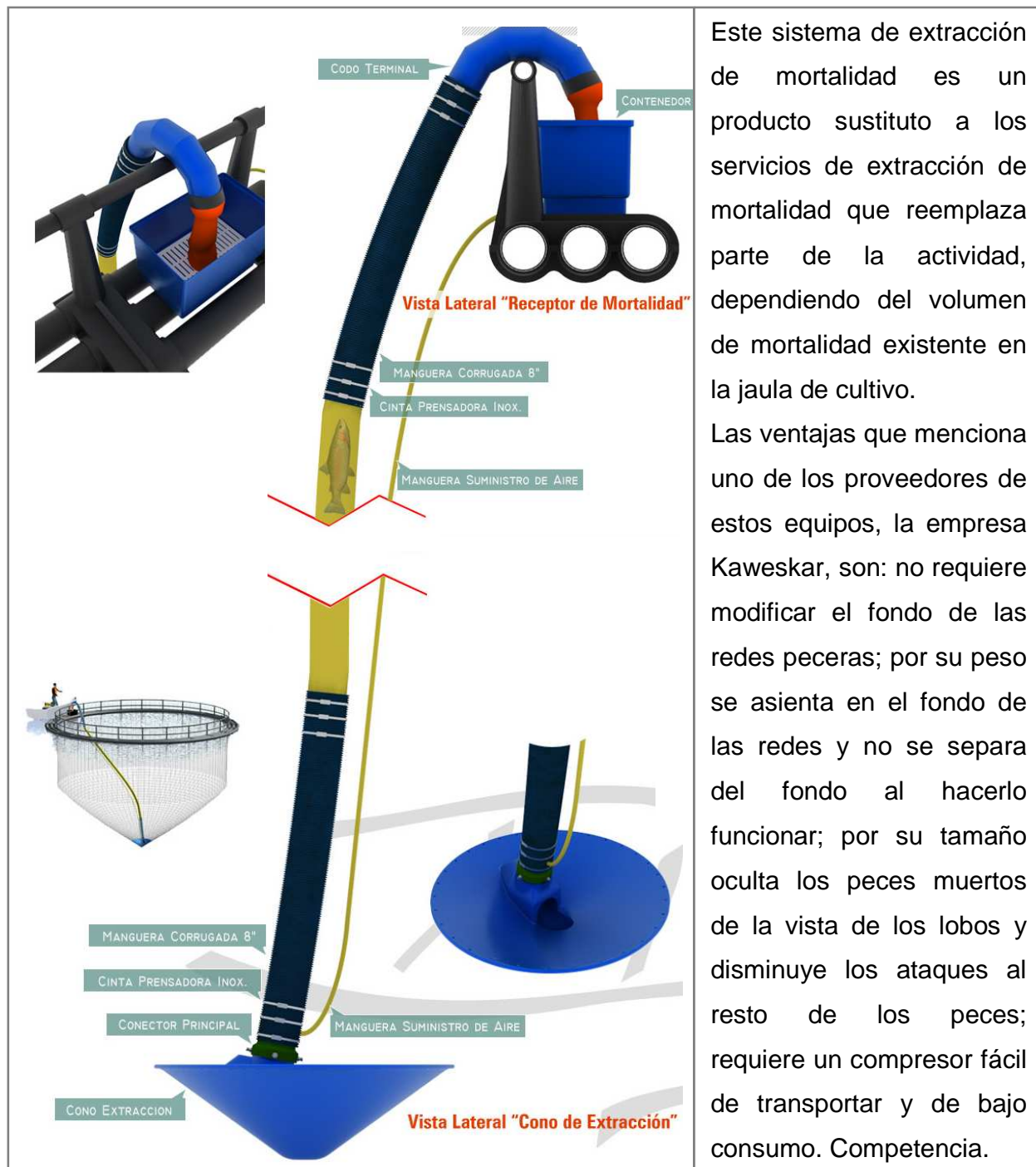
FIGURA N°27: Sistema de recepción y extracción de mortalidad.
