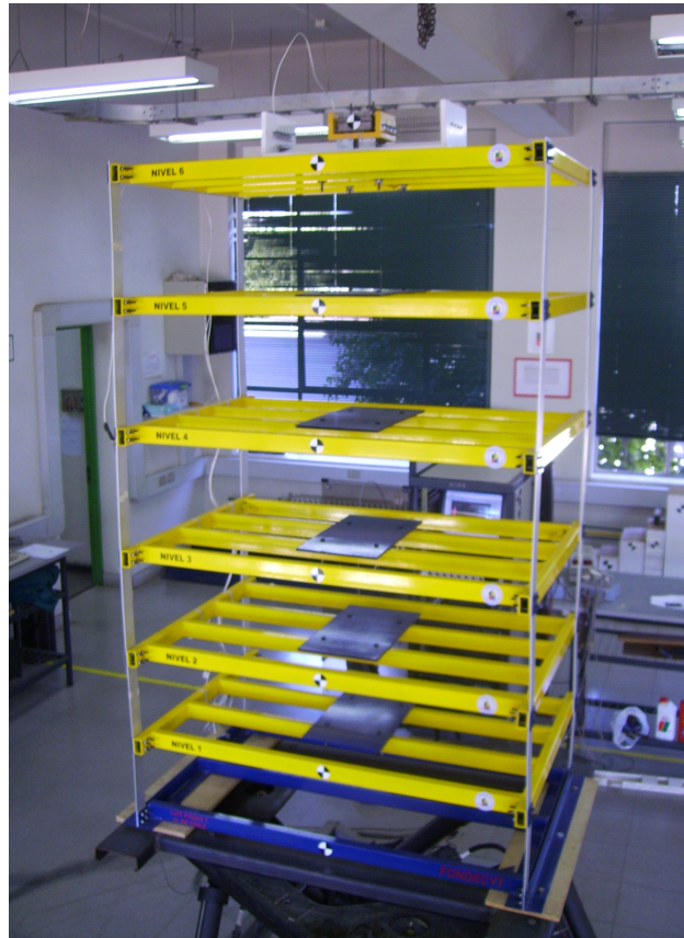
Figura 5.8: Estructura y disipador de masa sintonizada.
