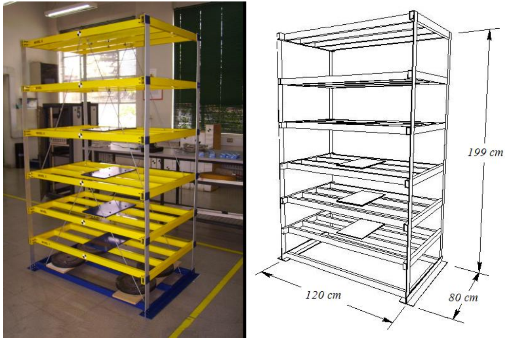
Figura 5.1: Estructura a controlar por los dispositivos. A la derecha se muestra un esquema de la misma junto con sus dimensiones principales.
