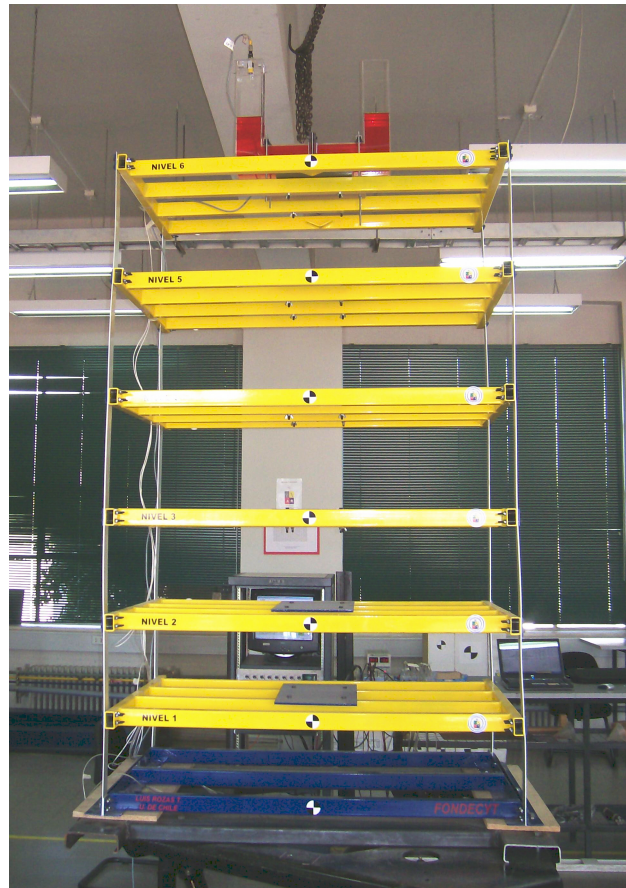
Figura 5.12: Estructura y disipador de columna líquida sintonizada.
