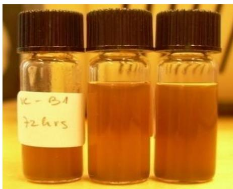
Figura D-9: La figura representan las muestras en triplicado para el caso de Leng a 121°C, por 60 minutos pretratados con [emim][Cl].
