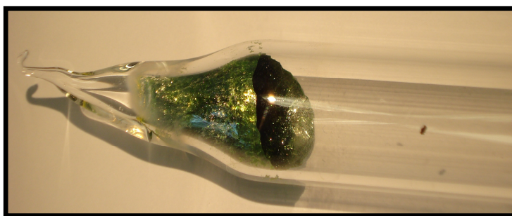
Figura 15. Ampolla de cuarzo con producto correspondiente a la fase \text{MnPS}_3
