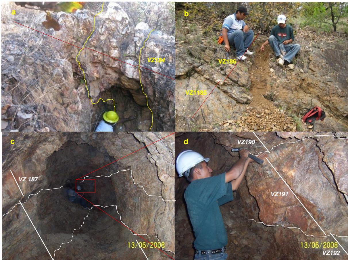
**Figura 10.** a) Socavón labrado a rumbo de veta de cuarzo; b) muestreo en veta falla, y c, d) aspecto de muestreo en obra tanto al alto como al bajo de la veta.
