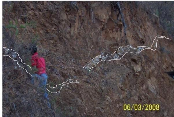
**Figura 12.-** Nótese estructura representada por delgada veta de cuarzo y vetillas emplazada en el paragneis.
