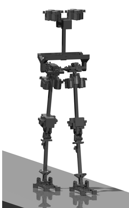
(a) Modelo mecánico del robot con el conjunto de parámetros obtenido usando la metodología propuesta.
