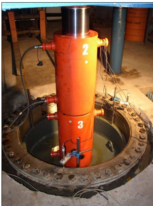
A1.25 - Aplicación de carga axial sobre pistón
