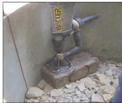
Figura 4.4 Ensayo de densidad máxima en partículas de gran tamaño.
