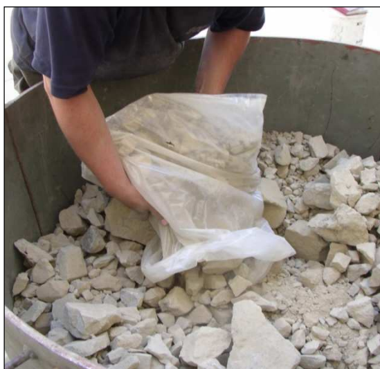
Figura 4.3 Ensayo de densidad mínima en partículas de gran tamaño.
