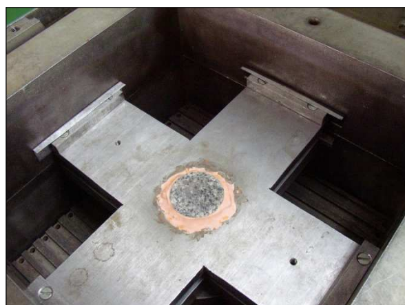
h) Disposición al interior de la caja de corte directo
