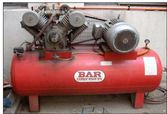
Figura 4.13 a) Bomba de triple pistos. b) compresor de aire (IDIEM).
