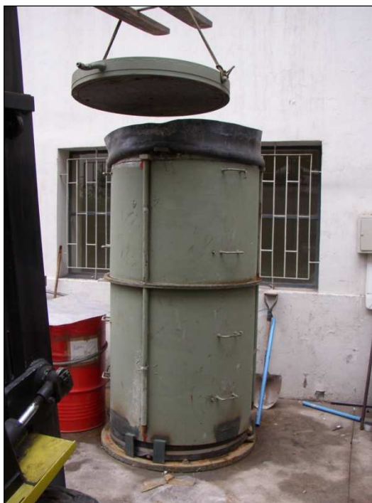
A1.5 - Molde metálico externo para remoldeo de la probeta
