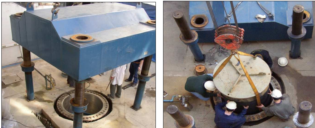
Figura 4.9 Marco de reacción de ensayo triaxial gigante (IDIEM).
