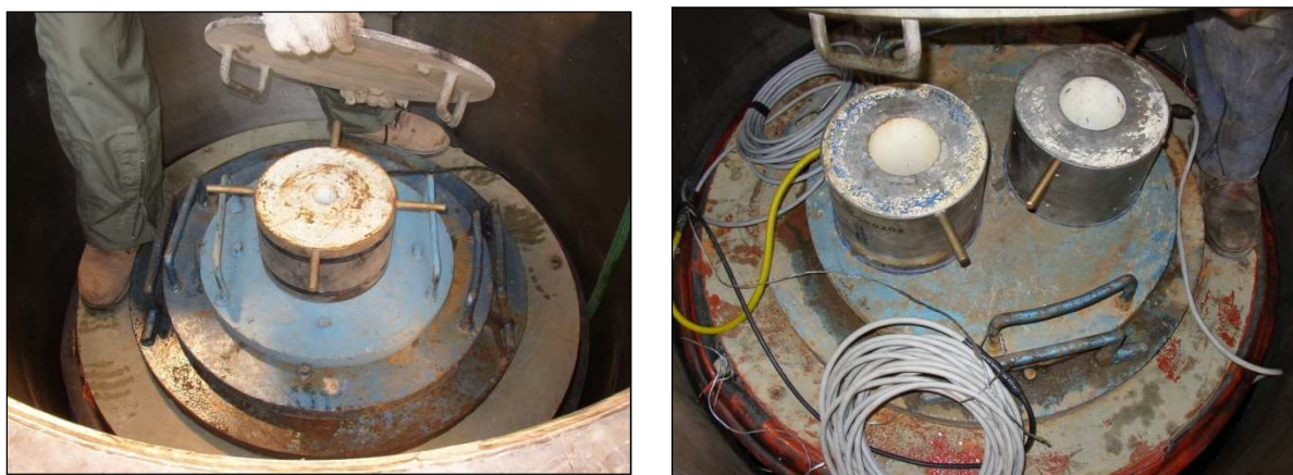
Figura 4.16 Celda de carga sumergible (IDIEM).
