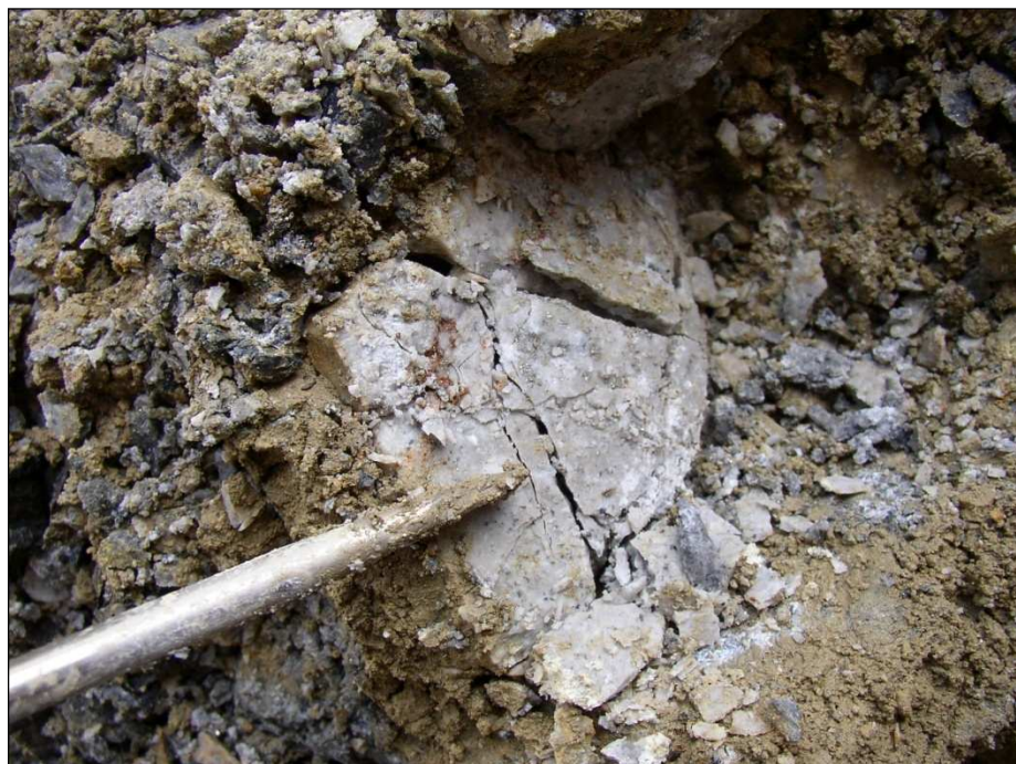
Figura A5.4 – Rotura de partícula
