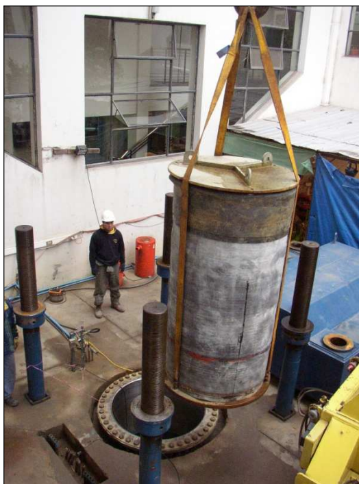
A1.15 - Traslado de probeta hacia la cámara triaxial
