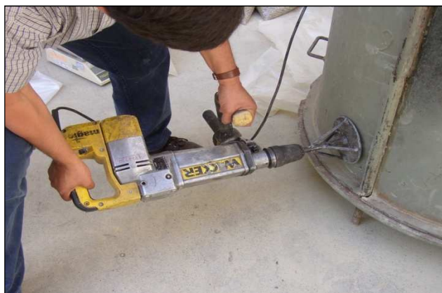
Figura 4.4 Ensayo de densidad máxima en partículas de gran tamaño.
