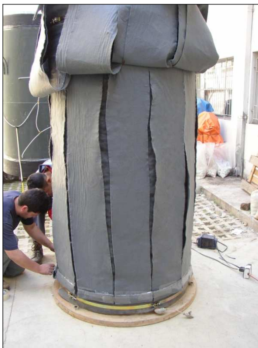
A1.11 – Capas intermedia de geotextil entre membranas
