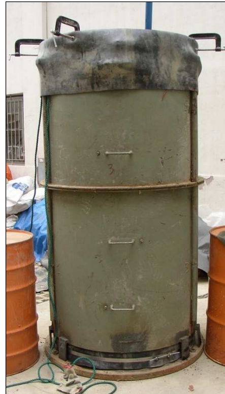
b) Molde Metálico para construcción de probeta
