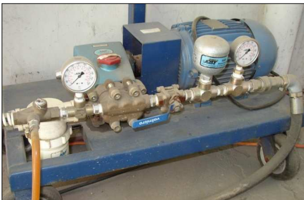
Figura 4.13 a) Bomba de triple pistos. b) compresor de aire (IDIEM).
