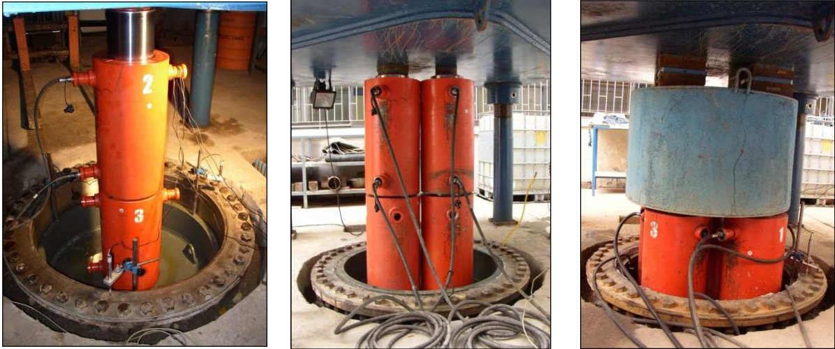
Figura 4.11 Configuración del sistema de carga (IDIEM).
