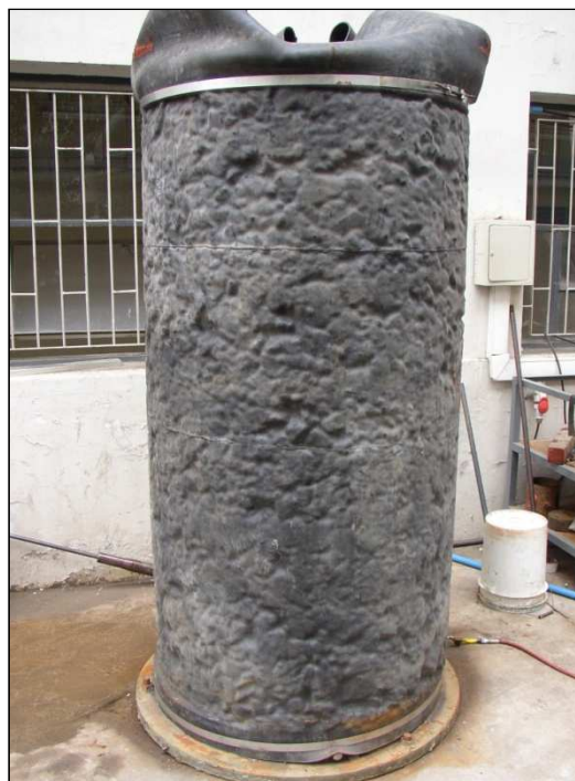
A1.10 - Aplicación de vacío a la probeta
