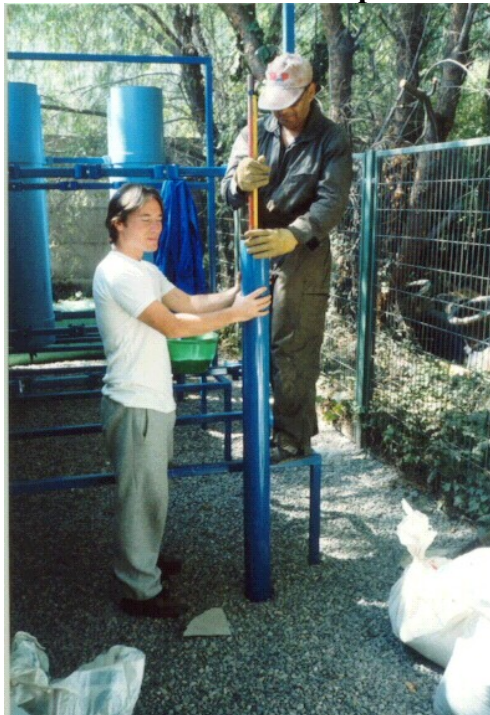
Figura A3.2 Llenado de las Columnas Experimentales
