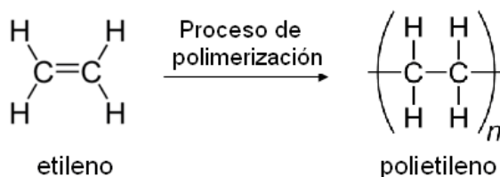
Figura 2.3: Esquema de la polimerización de etileno.
