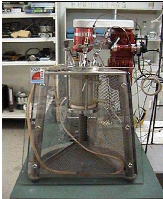
Figura 3.3: Reactor para polimerización de propileno.
