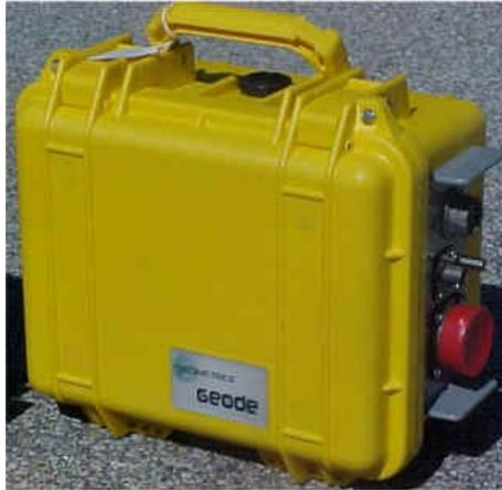
Figura 5.2 Equipo de adquisición de datos, GEODE.
