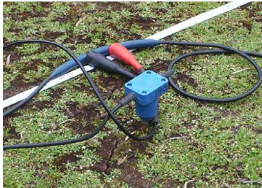
Figura 5.1 Sensor de velocidad, De 14 Hz, en el sector de Lo Aguirre.
