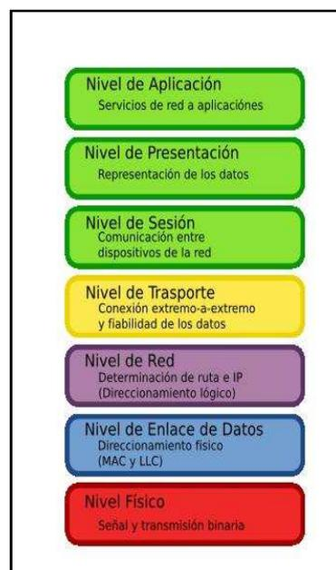
Figura 29: Esquema del Modelo OSI.
