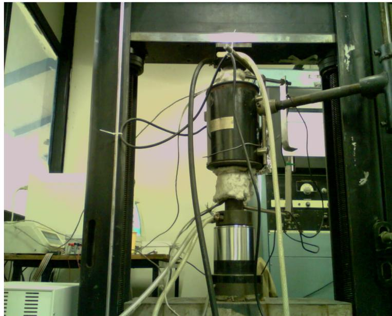
Figura 4.1: Máquina Instron TTDM modificada.
