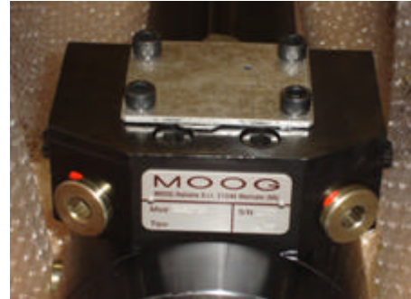
( b ) Servo-actuador detalle de zona de conexiones entre el servo-actuador y la servo-válvula, además se muestra el detalle de la conexión para los acumuladores de ½ [gls].
