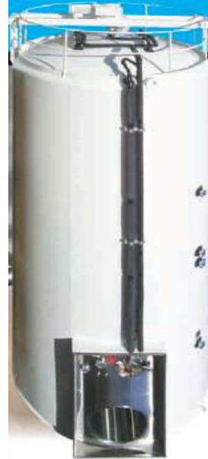
Ilustración 11: cristalizador tanque del tipo interior
