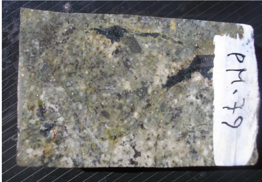
FIG. 10. Vetillas de magnetita en stock andesítico. Muestra de 4 cm de largo, aproximadamente.
