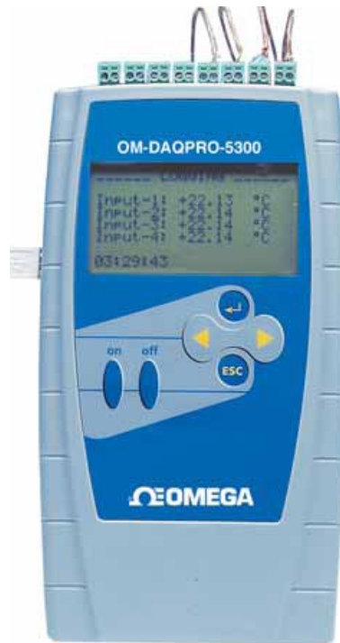
Figura 3.2: Equipo Data Logger marca Omega, modelo DaqPro 5300. Imagen obtenida del catálogo del equipo.
