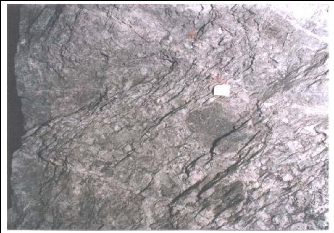
Foto N°3: Clivaje de fractura afectando brecha de biotita en XP-39, nivel 3093. (foto mirando al N)
