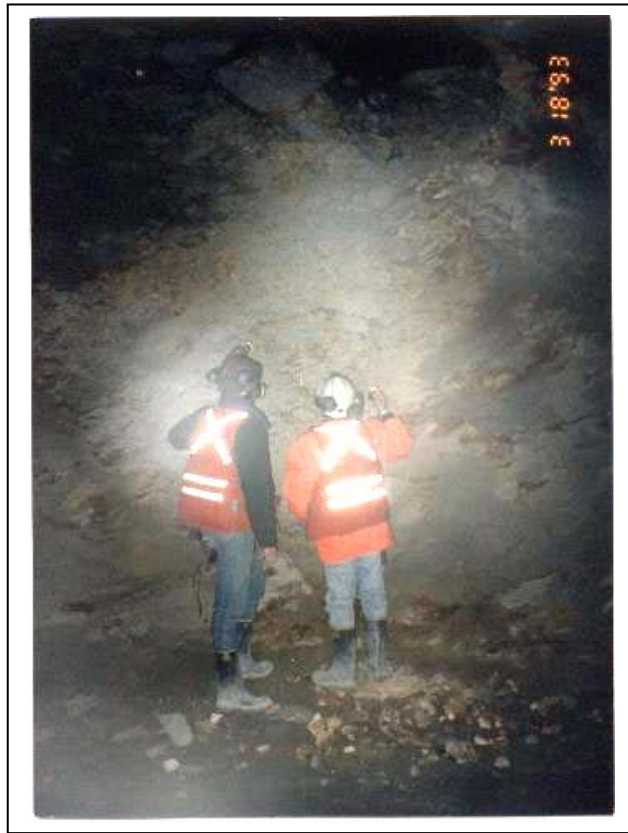
Foto N°4: Oquedad en la pared oeste del slot S1-S2, del nivel 3104, en brecha de biotita con cizalle N30°W/50°W, de 3m de diámetro y 5 m de profundidad.
