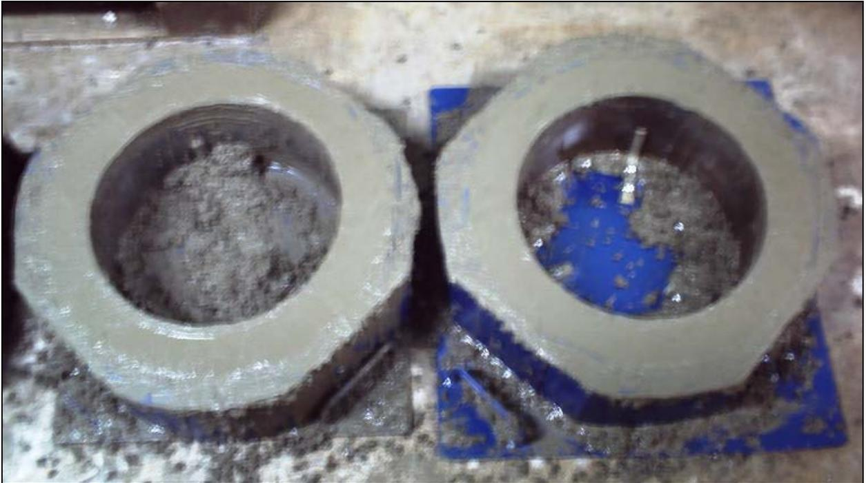
Figura N°4.5 Confección de probetas de retracción restringida
