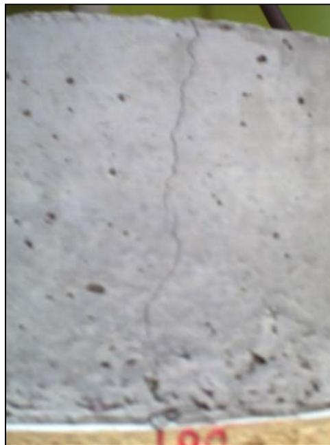
Figura N°4.11 Fisura en probeta de retracción restringida
