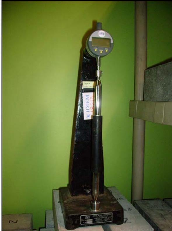
Figura N°4.9 Instrumento utilizado para medir retracción libre
