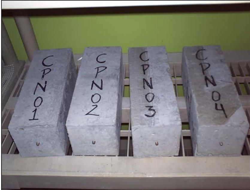
Figura N°4.6 Probetas de retracción libre desmoldadas
