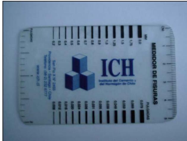
Figura N°4.10 Regla utilizada para medir fisuras
