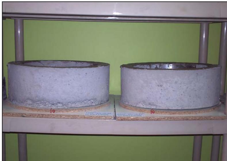
Figura N°4.7 Probetas de retracción restringida en ambiente de prueba
