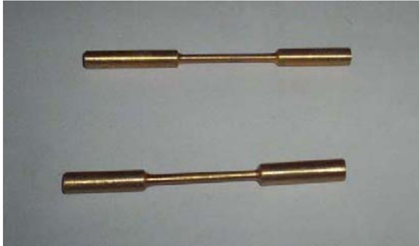
Figura 2.3: Forma típica de las probetas ensayadas a tracción [1].
