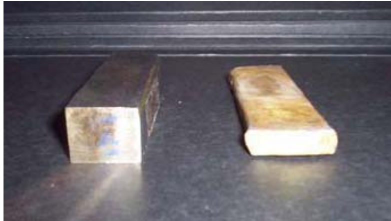
Figura 2.2: Contraste entre lingote laminado y no laminado [1].
