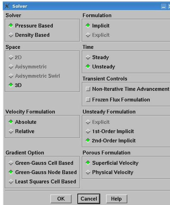
Figura 3.7: Opciones del solver utilizadas en Fluent
