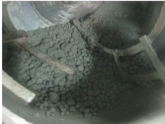
Figura 16 Mezcla cemento + árido reciclado + mitad del agua
