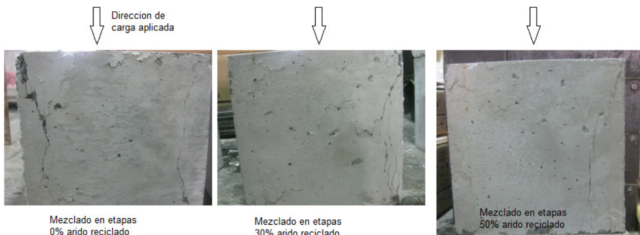
Figura 36 Fisuras del cubo patrón - mezclado en etapas
