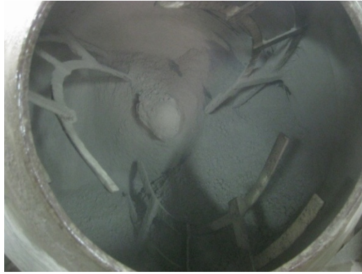
Figura 15 Mezcla del cemento y del árido reciclado
