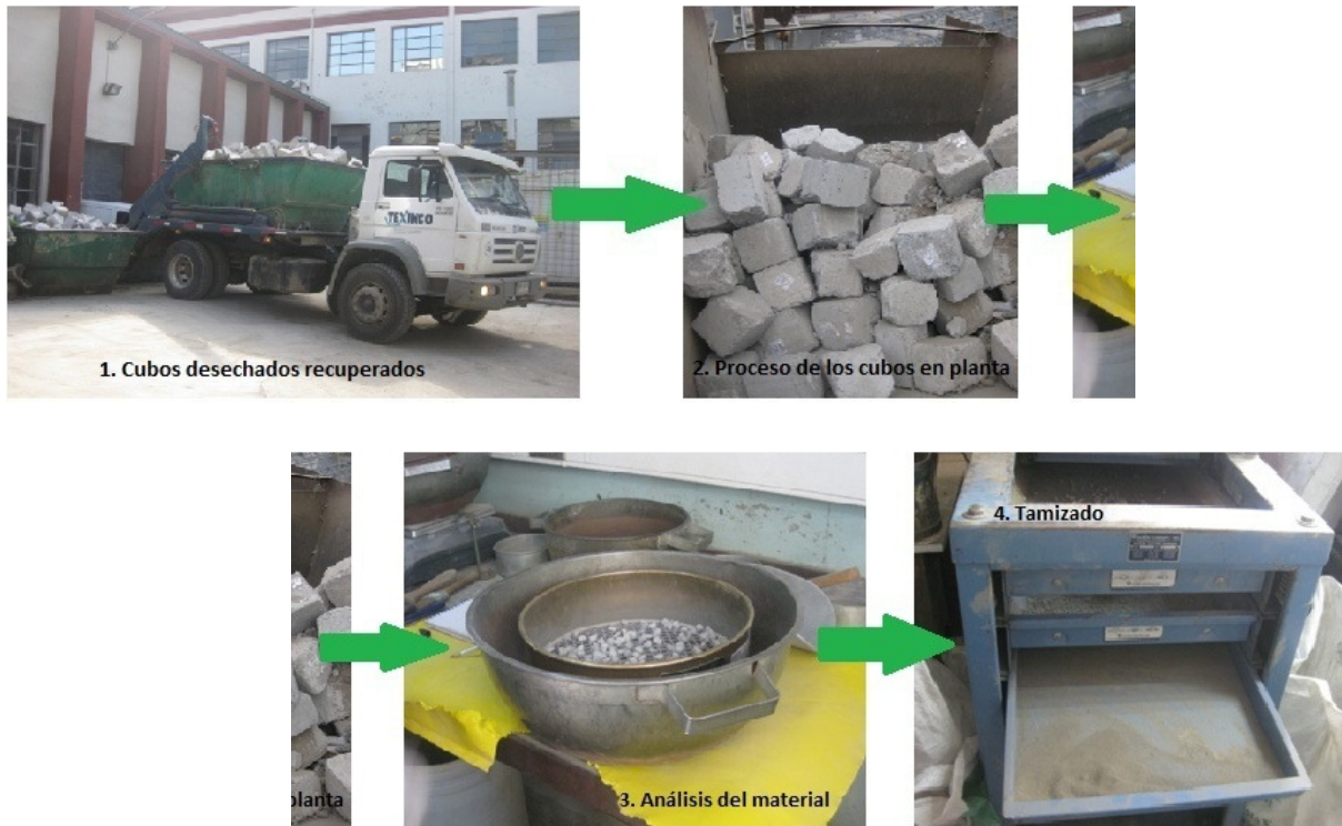
Figura 9 Proceso total de obtención del árido reciclado
