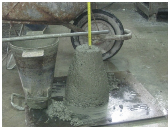
Figura 20 Medida del asentamiento de cono de Abrams
