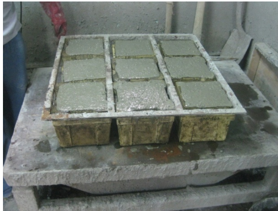
Figura 18 Vibración de las probetas
