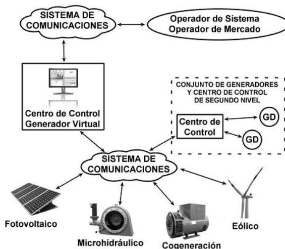
Figura 2.2: Esquema generalizado de un generador virtual (fuente Andrés Vargas [4]).
