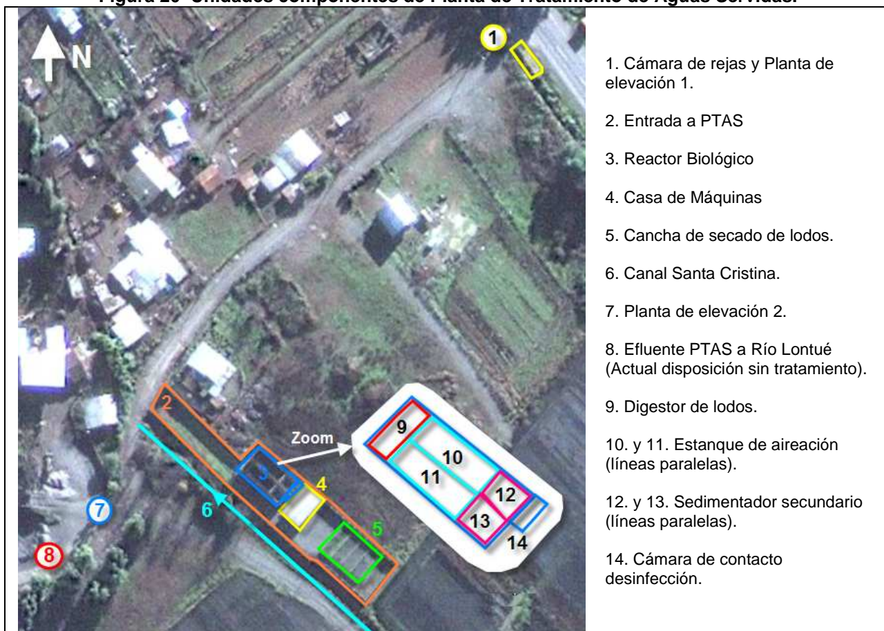
Figura 20 Unidades componentes de Planta de Tratamiento de Aguas Servidas.
