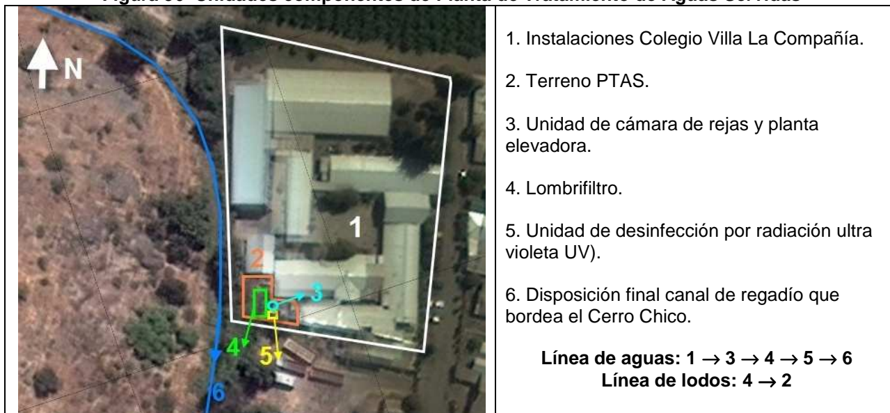
Figura 36 Unidades componentes de Planta de Tratamiento de Aguas Servidas
