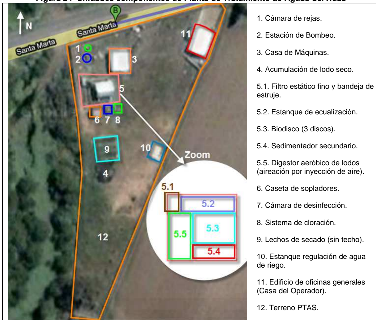
Figura 24 Unidades componentes de Planta de Tratamiento de Aguas Servidas
