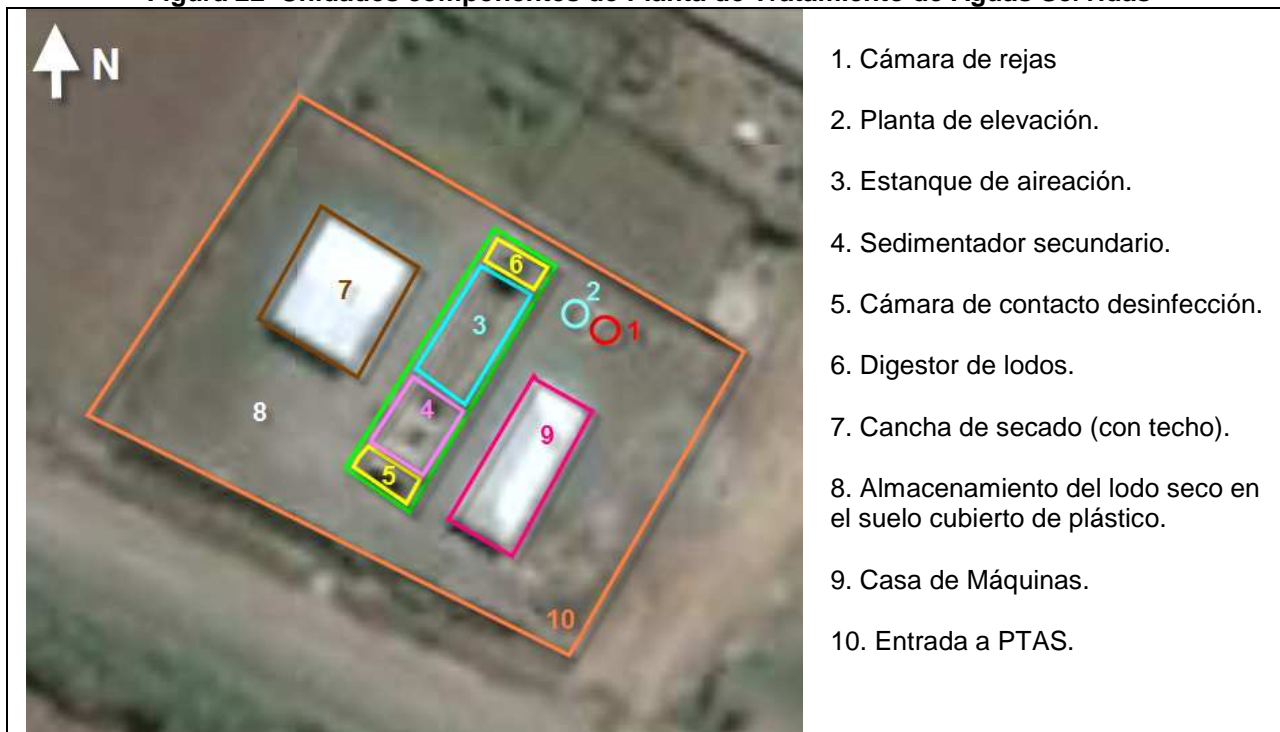
Figura 22 Unidades componentes de Planta de Tratamiento de Aguas Servidas
