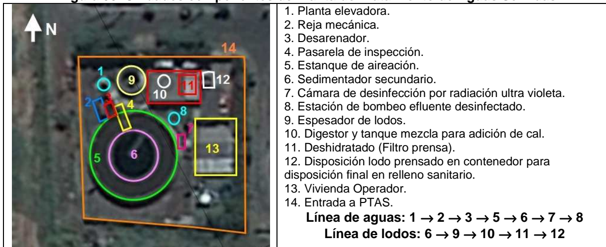
Figura 39 Unidades componentes de Planta de Tratamiento de Aguas Servidas
