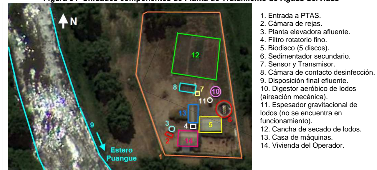
Figura 34 Unidades componentes de Planta de Tratamiento de Aguas Servidas
