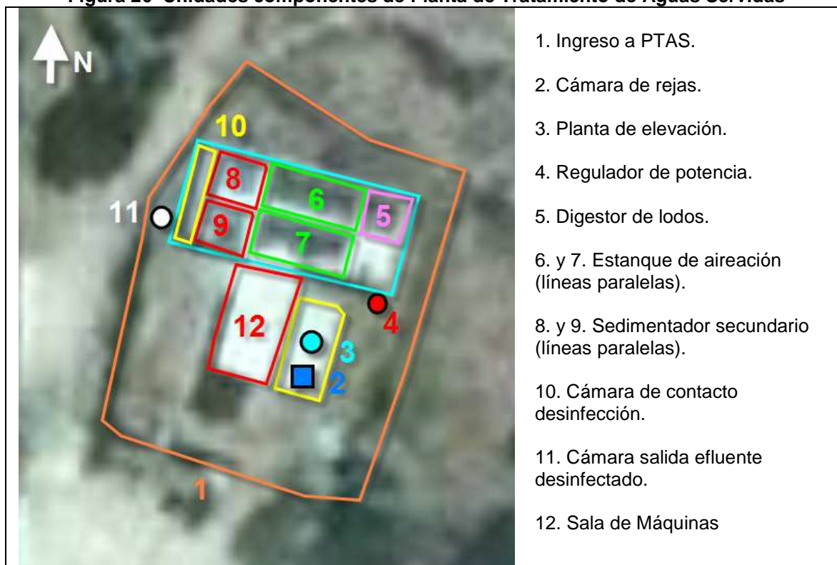
Figura 26 Unidades componentes de Planta de Tratamiento de Aguas Servidas
