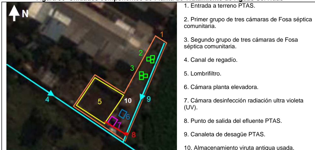
Figura 30 Unidades componentes de Planta de Tratamiento de Aguas Servidas
