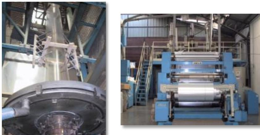
**Imagen 1. Extrusora de tipo burbuja (izquierda) y de tipo Cast (derecha).**
