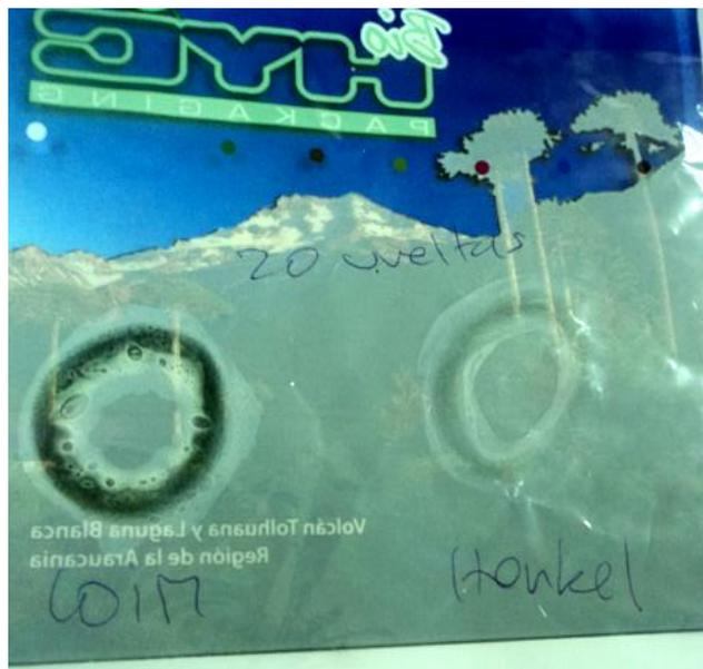
**Imagen 8. Fotografía de prueba de remoción de tinta con adhesivos COIM y Henkel.**
