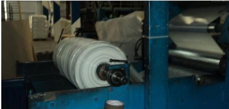
**Imagen 2. Fotografía de bobina de Ecoflex con problemas de embobinado.**
