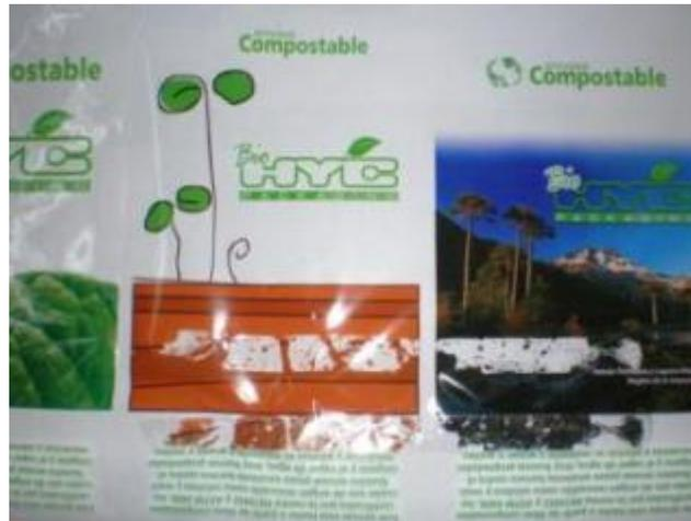
**Imagen 5. Fotografía del resultado de la prueba del scotch aplicada a la impresión hecha a 120°C**
