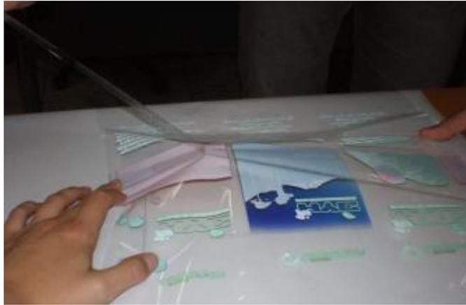
**Imagen 7. Fotografía de la realización de la prueba del scotch para impresión a 180°C.**
