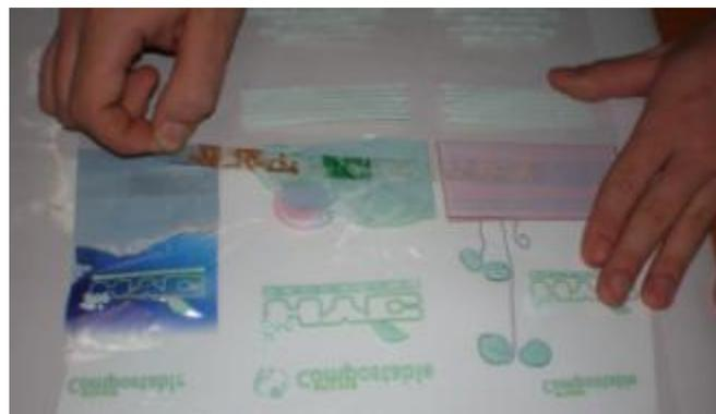
**Imagen 6. Fotografía de la realización de la prueba del scotch para impresión realizada a 160°C.**
