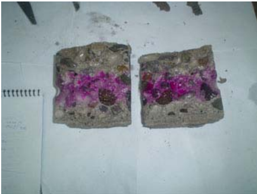
Foto N°64 : Determinación de la profundidad de carbonatación
