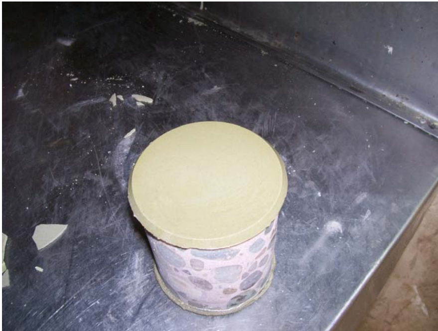
Foto N°87 : Refrentado del testigo para ensayarlo a compresión
