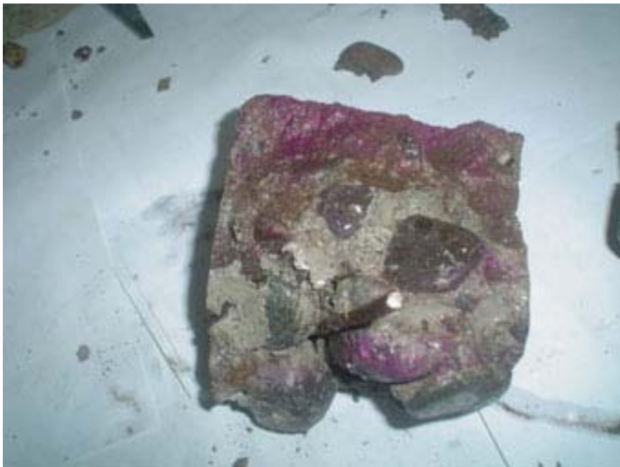
Foto N°66 : Determinación de la profundidad de carbonatación
