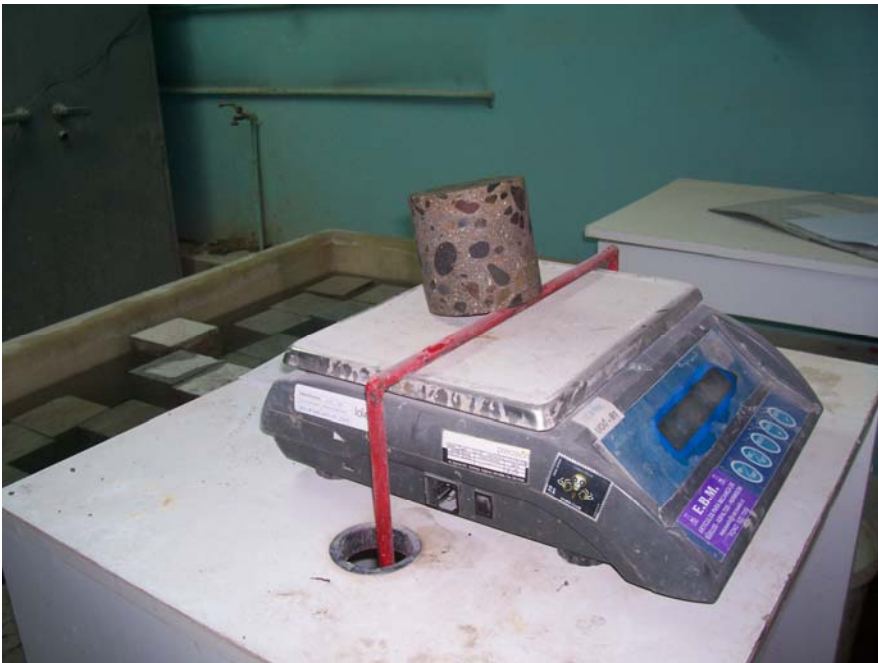
Foto N°86 : Se pesa el testigo para determinar densidad
