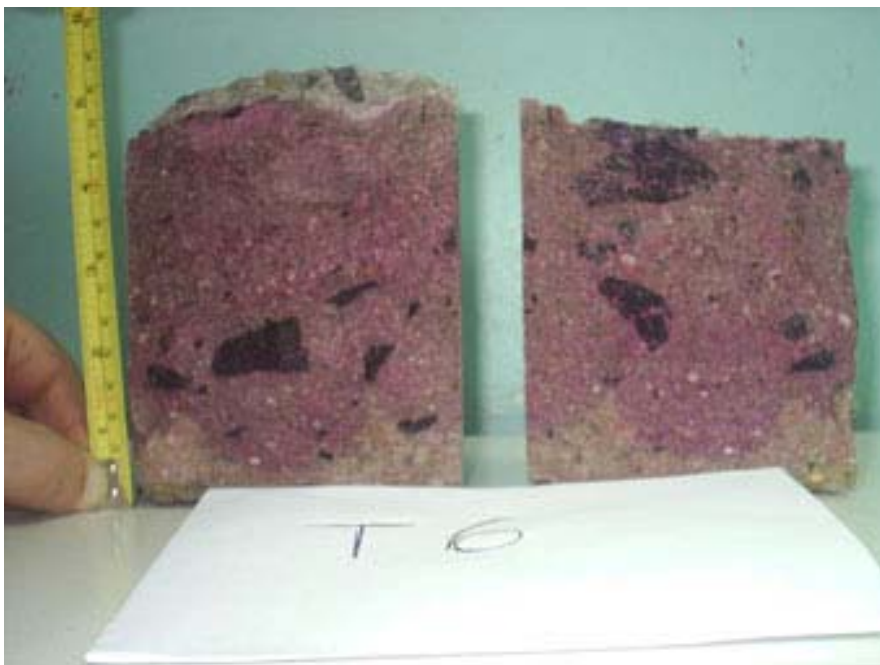
Foto N°36 : Muestras después del ensayo de hendimiento
