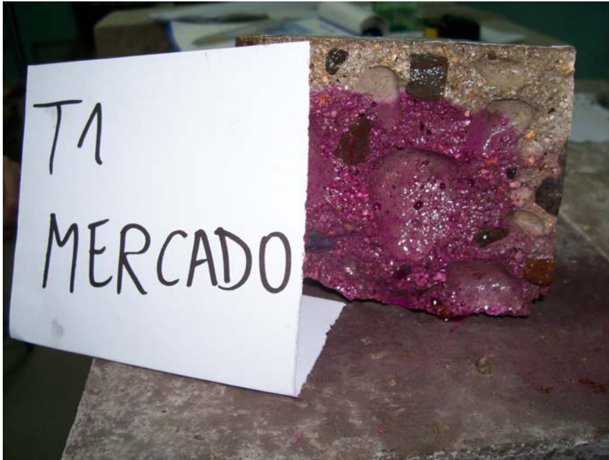
Foto N°89 : Medición de profundidad de carbonatación después del ensayo de hendimiento
