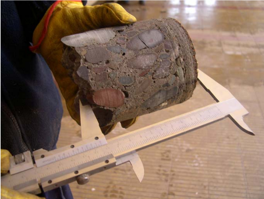
Foto N° 47: Proceso de extracción de testigos
