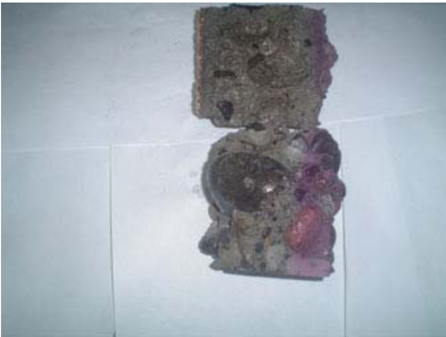
Foto N° 62: Determinación de la profundidad de carbonatación
