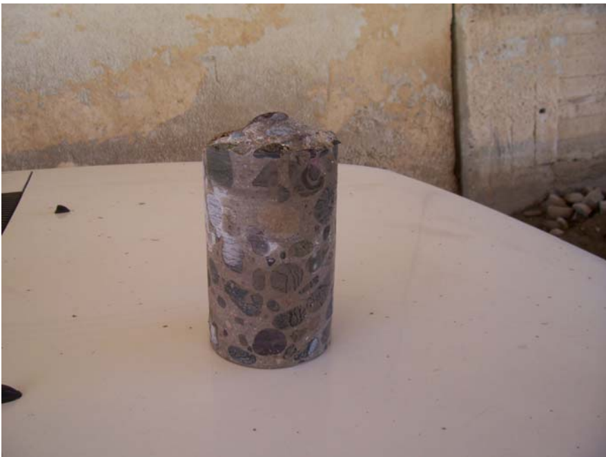
Foto N°82 : Extracción de testigo
