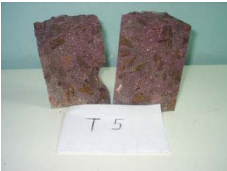
Foto N° 38: Muestras después del ensayo de hendimiento
