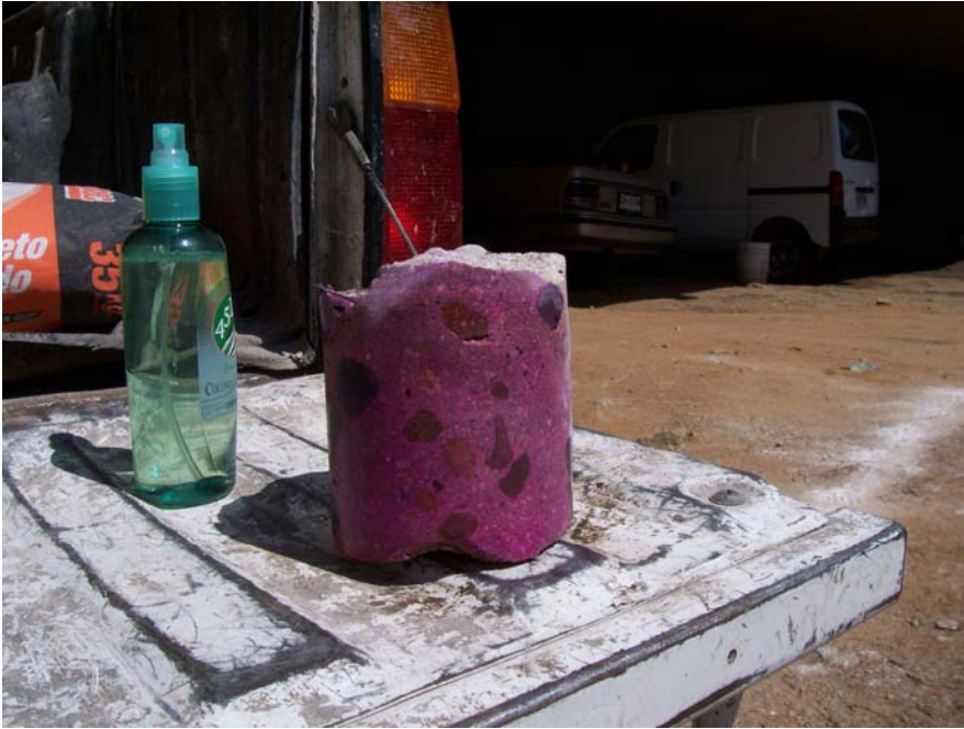
Foto N° 81: Medición profundidad de carbonatación
