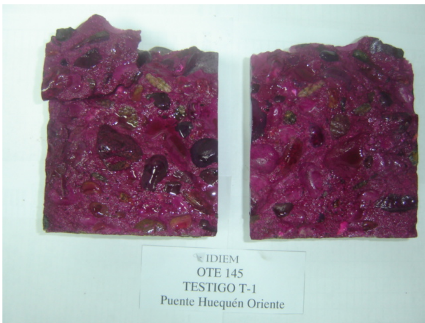
Foto N° 78: Testigo sin carbonatación
