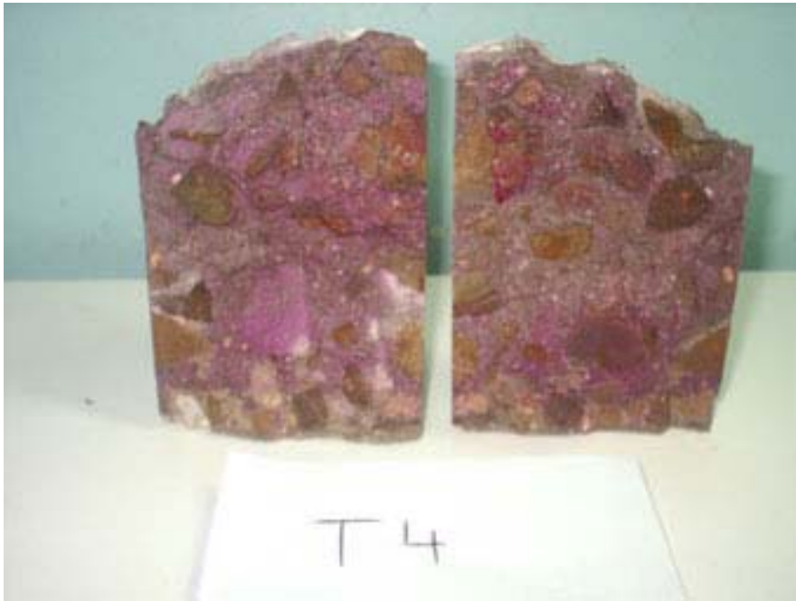
Foto N°37 : Muestras después del ensayo de hendimiento
