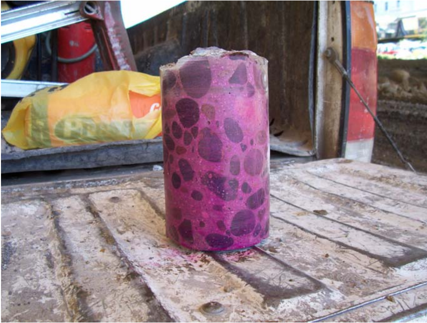
Foto N°83 : Medición profundidad de carbonatación en terreno
