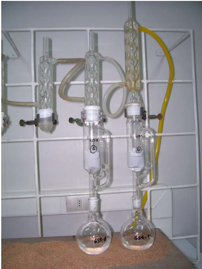
Foto N° 10 : Sistema de Lixiviación
