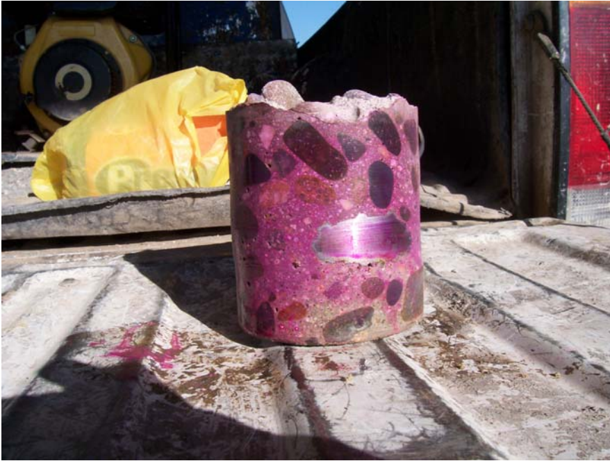
Foto N°85 : Medición profundidad de carbonatación en terreno. Posteriormente se realizó ensayo de hendimiento.
