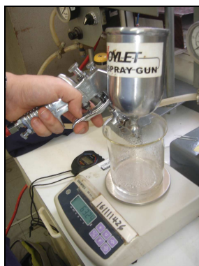
Figura N° 3.2: Aforo y Calibración del flujo de Pistola.
