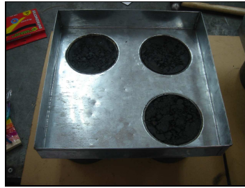
Figura N° 3.4: Bandeja Metálica con 3 probetas preparadas para aplicación de riego.
