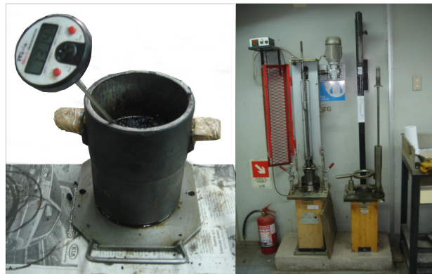
Figura N° 3.6: Molde, Collarín y Martillo Marshall.
