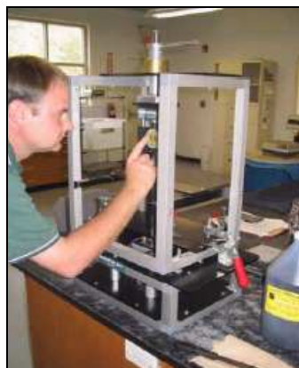
Figura N° 2.15: Dispositivo ATACKER para tensión entre capas con riego de liga.
