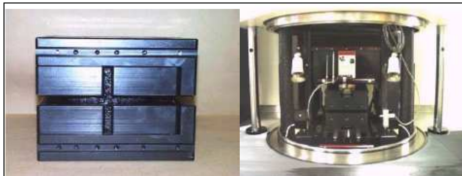
Figura N° 2.12: Caja de Corte con muestra preparada. Caja de Corte en SST.
