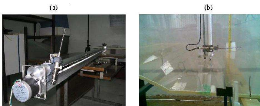
Figura 8.5: Sistema motorizado para la posición y el movimiento de la punta del alambre caliente de prueba. (a) Detalles del soporte de la punta del alambre caliente de prueba, del motor de pasos y del carril. (b) Detalles del posisionamiento del sistema-Z con la punta del alambre caliente de prueba montado en la sección S10 del modelo.
