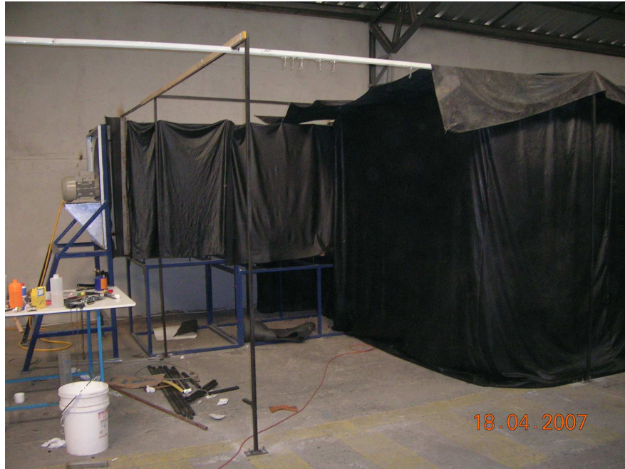
Figura 8.10: Fotografía de la maqueta, a la izquierda se puede observar el extractor de aire
