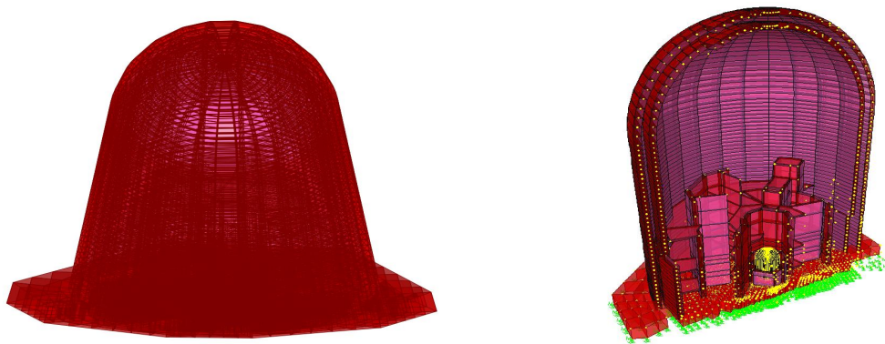
Figura 4.12: Modelo completo del reactor nuclear considerando suelo de fundación
