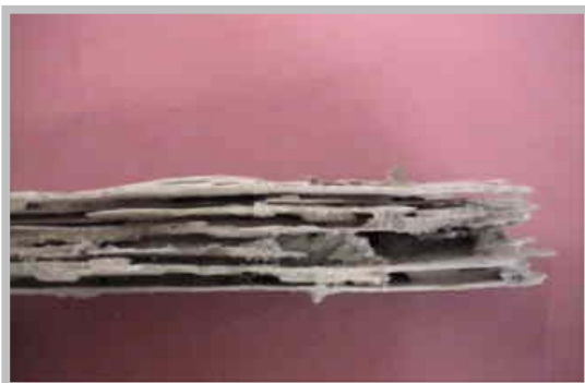
Figura N°3: Ataque causado por termitas
