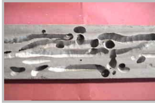
Figura N°5: Madera atacada por Bankia
