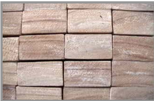
Figura N°39: Probetas MB con 1 mes de biodeterioro
