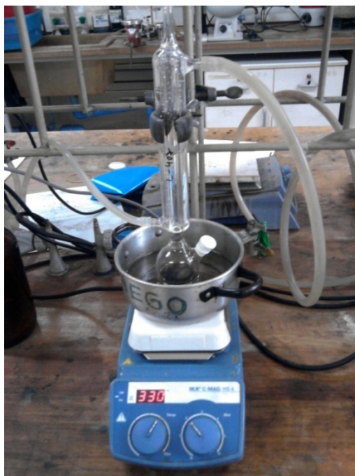
Figura 10.- Reactor catalítico utilizado en la reducción de cetonas e iminas mediante transferencia de hidrógeno.
