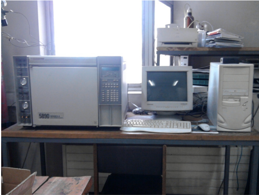
Figura 12.- Cromatógrafo gaseoso HP 5890 series II, provisto con un detector FID y acoplado a una computadora para la adquisición de datos. Para la integración y asignación de las señales se utilizó el software Allchrom Plus.
