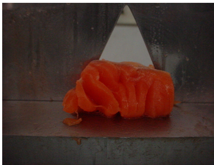
Figura 5C: Análisis de Firmeza mediante test de cizalla en Salmón coho congelado a -20^{\circ}\text{C} , correspondiente al mes 10.
