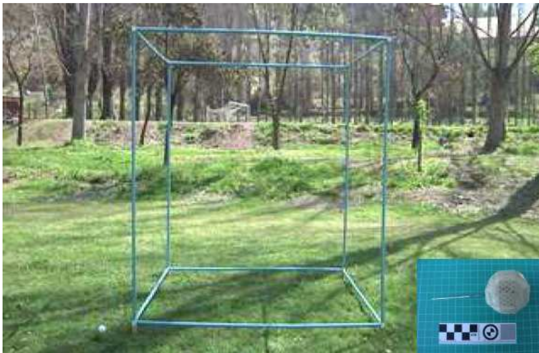
Figura 6: Cubo de 2x2 de calibración Abajo costado derecho : Marcador fijo refractario utilizado.
