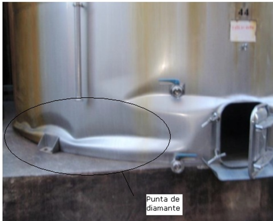
Figura 2-18: Pandeo punta de diamante [2]
