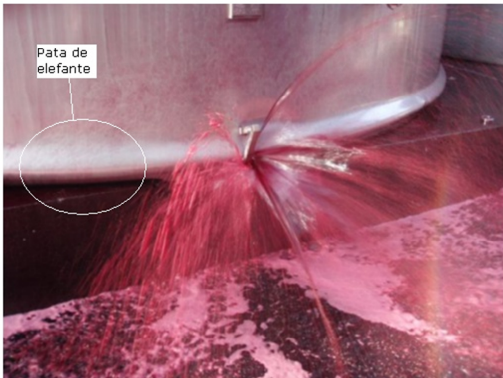
Figura 2-19: Pandeo pata de elefante [2]
