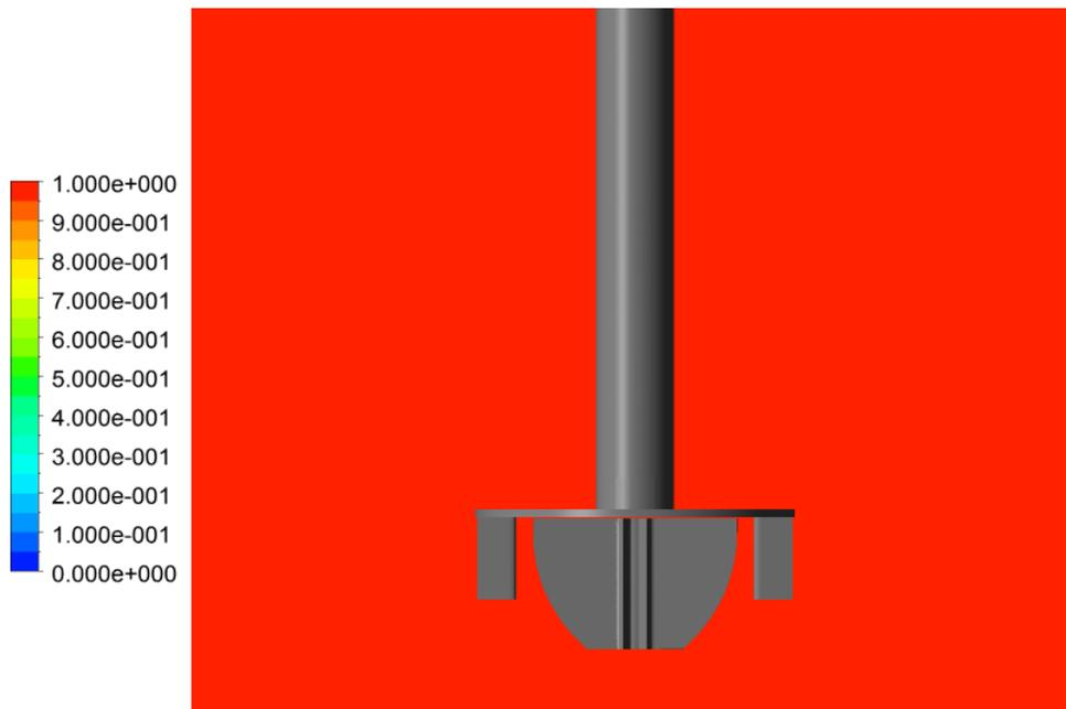
Figura 4.30: Probabilidad de estabilización para partículas de diámetro 20 [µm] al cabo de 60 segundos.
