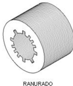
FIGURA 2.10: ESTATOR DE TIPO RANURADO Y NÚCLEO LAMINADO.
