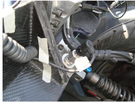
(b) Acelerómetro Suspensión Trasera
