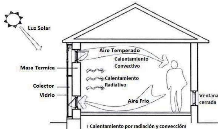
Figura 3.6: Vivienda equipada con un muro Trombe
