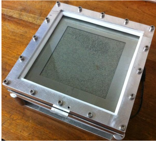
Figura 1: Contenedor de partículas y retro-iluminación.
