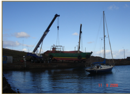
Imagen N° 21. Proceso de descarga de las barcazas por medio de gruas. Fuente: Dirección de Obras Municipales.
