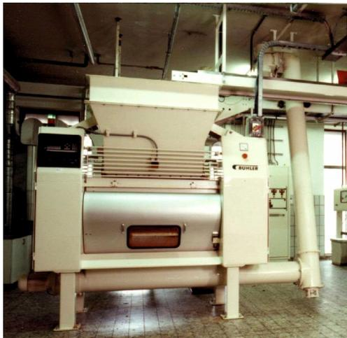
**Figura 2.3:** Pre-refinador de dos cilindros. Marca Buhler.
