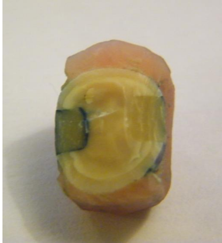
Fotografía N°4: Se observa la penetración del colorante antes de ser sometido al microscopio óptico
