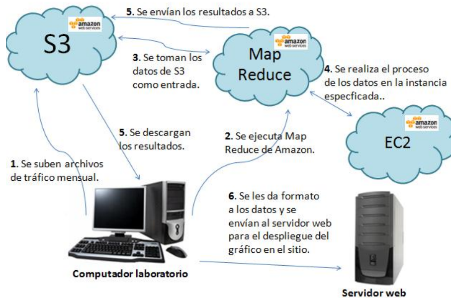
Diagrama 9: Sistema de procesamiento de datos de la darknet en la nube.2012.
